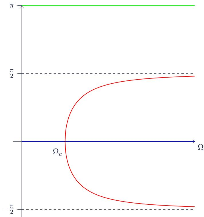
**4.** Si  $\Omega > \Omega_c$ , la stabilité des positions  $\theta_{eq\pm}$  a été montrée dans le cours aux pages 8 et 9. Il est clair que  $\theta_{eq2} = \pi$  est toujours instable, on va donc s'intéresser à  $\theta_{eq1} = 0$ . On va faire un DL au voisinage de 0. On suppose que  $|\theta| \ll 1$ . On a donc :
